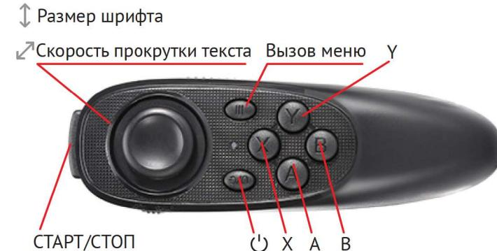
— кнопка включения пульта, после включения: на рабочем экране 2 — переход к экрану 1, на экране 1 — подтверждение выбора текста и переход к рабочему экрану
